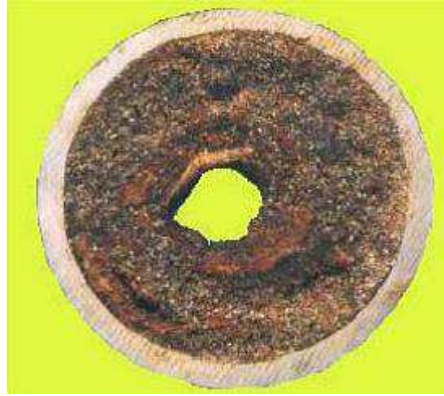
Figura 2.11: Bloqueio de linha por deposição de parafina.
