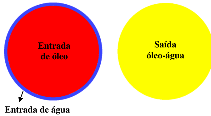
Figura 4.2: Ampliação e detalhe da região de entrada de água e óleo pesado e saída do duto horizontal.
