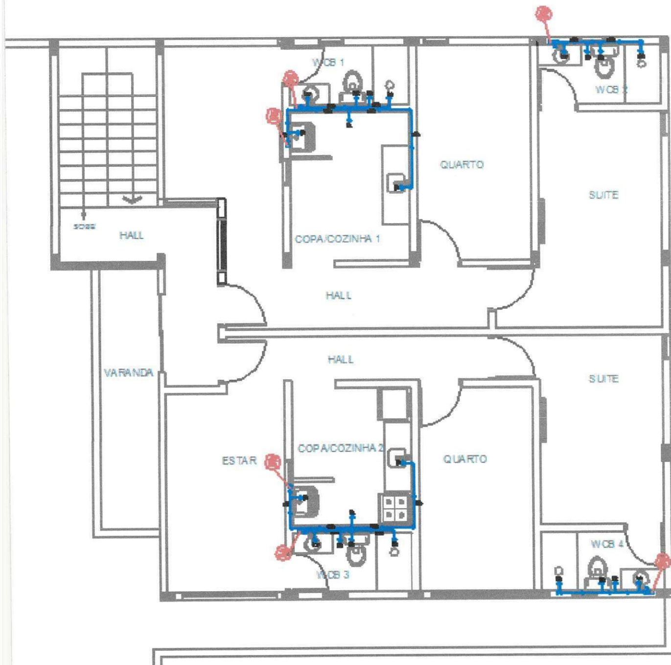
Figura 15 – Projeto hidráulico edifício Sara planta baixa tipo
