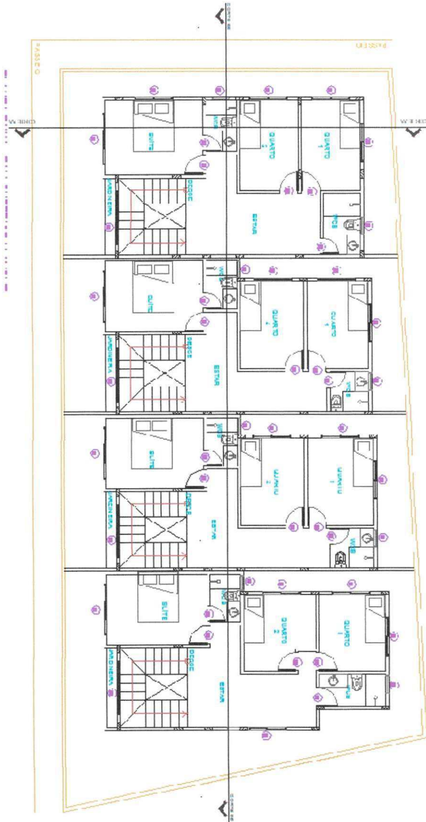
Figura 10 – Planta baixa pavimento superior duplex
