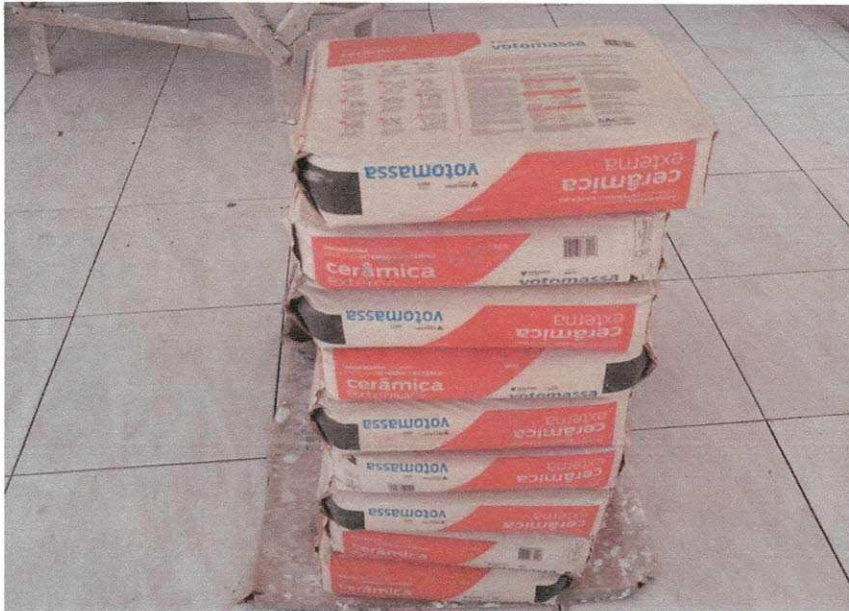
Figura 10-Argamassas para assentamento do revestimento.
