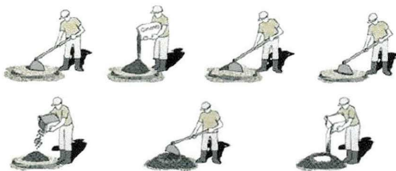
Figura 5 – Mistura manual do concreto.
