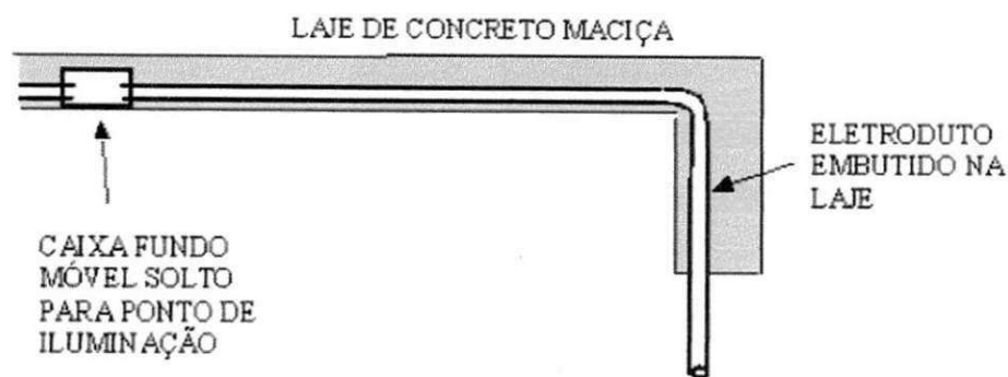
Figura 32 – Eletroduto percorre trechos horizontais embutido na laje de concreto e desce trechos verticais na parede
