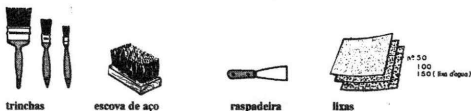
Figura 15 - Materiais utilizados no preparo e aplicação das pinturas em metais
