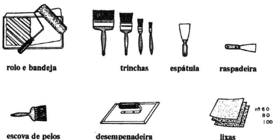
Figura 16 - Materiais utilizados no preparo e aplicação das pinturas em paredes
