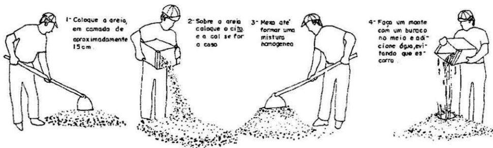
Figura 13 – Preparo manual de argamassa..
