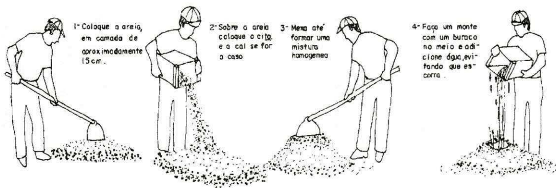
Figura 22. Preparação de argamassa manualmente
