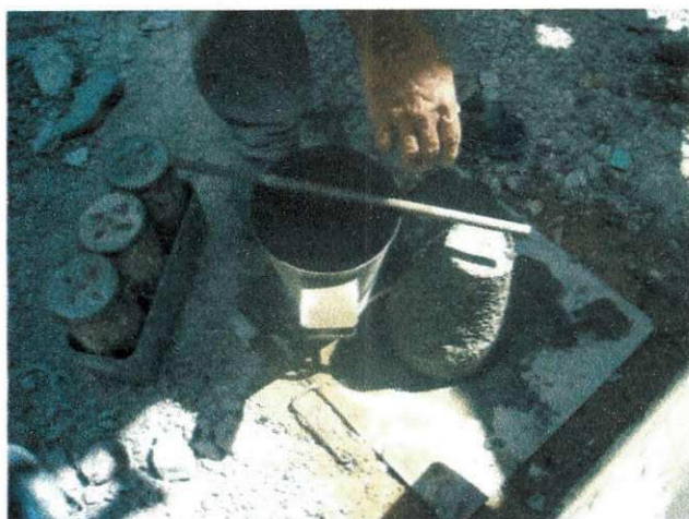
Figura 1- Slump test – recebimento do concreto usinado
