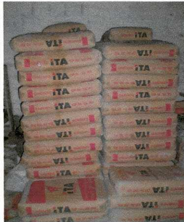
Figura 9.2- Empilhamento de cimento
