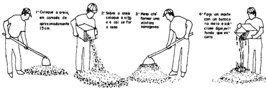
Figura 07 - Preparo manual de argamassa
