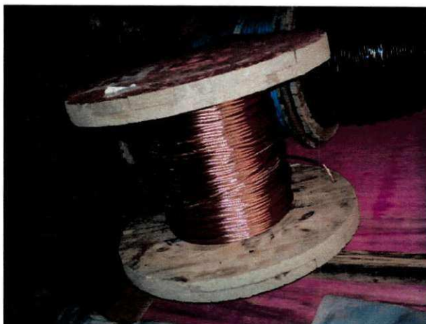
Figura 22 - Fios de cobre para aterramento e cabos de alta tensão
