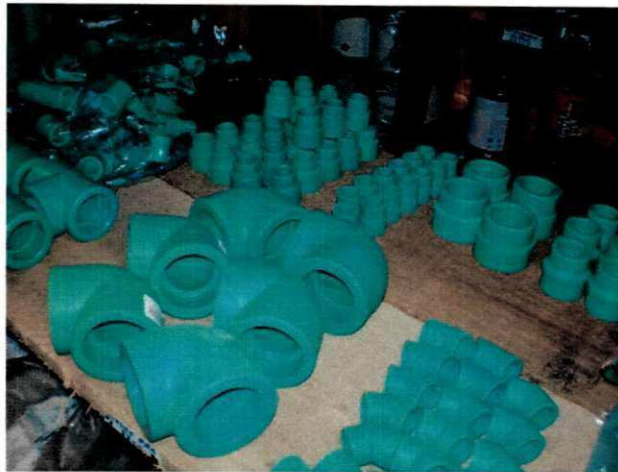
Figura 20 - Tubulação de água quente
