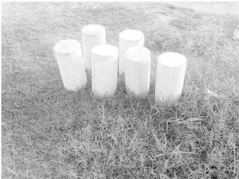
FIGURA 07 - Corpos de prova para ensaio de resistência característica do concreto ( f_{ck} )
