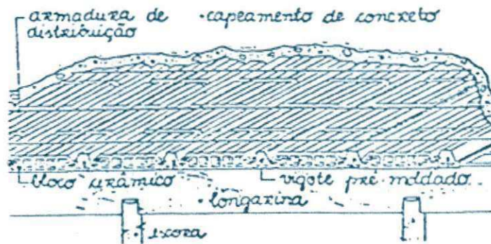
Figura 3.9- Esquema da laje com vigotes pré-moldados
