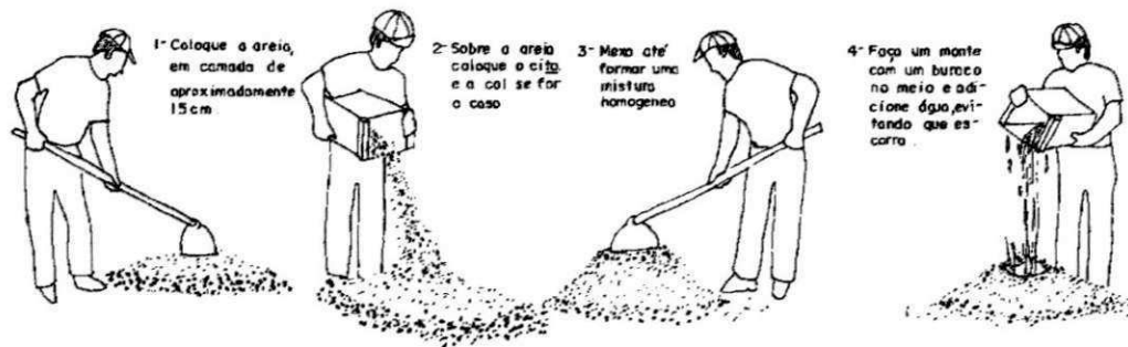
Figura 1 – Preparo manual de argamassa..
