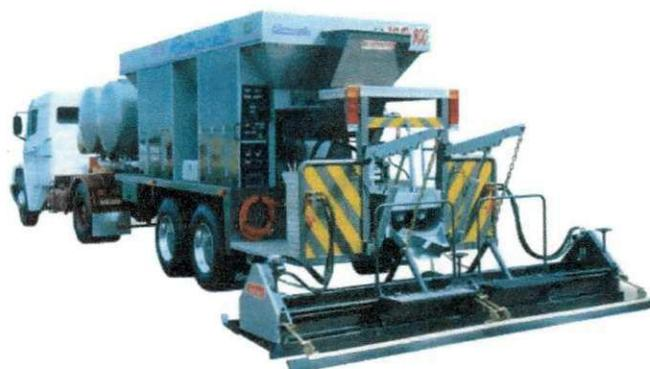
Figura 3.7 Exemplo de usina de microrrevestimento asfáltico.
