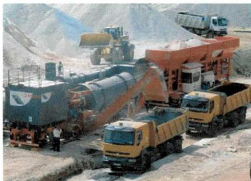
Figura 3.22 Exemplo de uma usina de asfalto contra-fluxo abastecendo caminhões.
