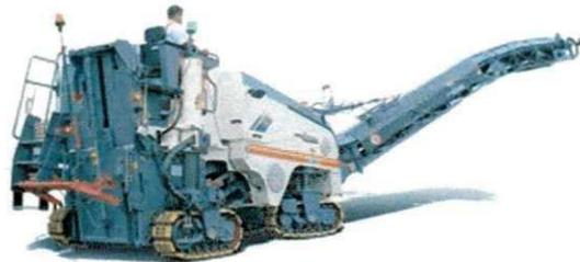
Figura 3.5 Exemplo de uma Fresadora de asfalto.
