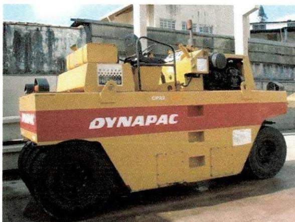
Figura 3.3 Exemplo de um rolo de pneus.
