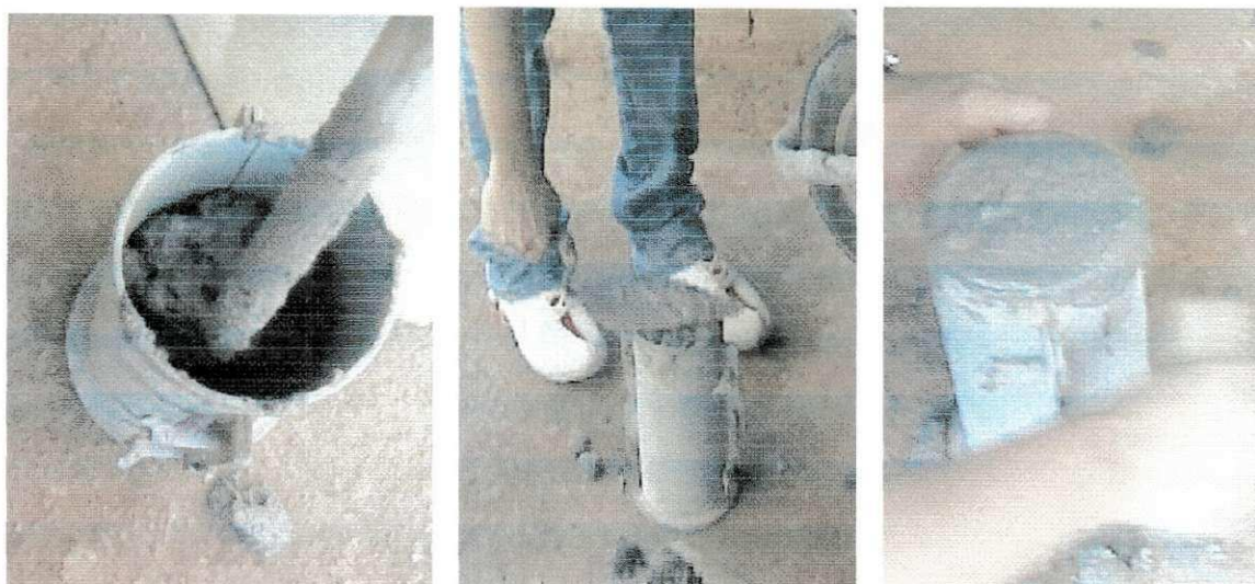
Figura 12 - Moldagem dos corpos de prova
