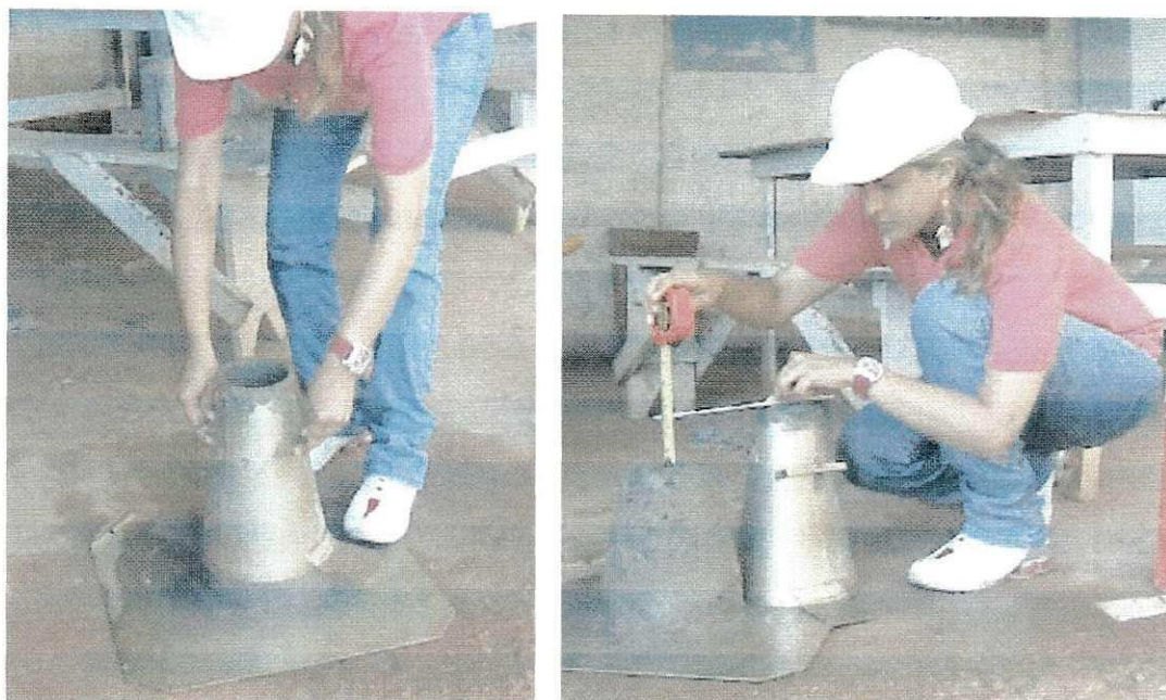
Figura 11 - Execução do teste de abatimento
