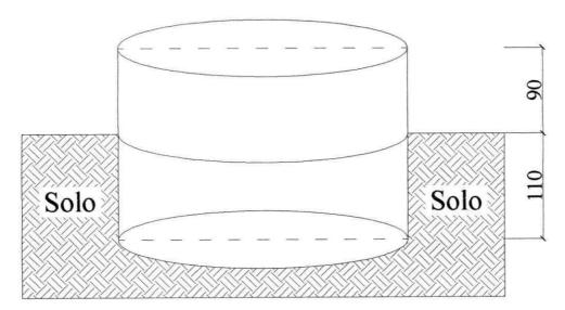
Figura 1: Esquema da cisterna
