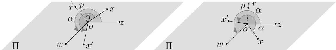
Figura 2.26: Bissetriz dos ângulos z\hat{o}x_{(o,\alpha)} e w\hat{o}x para 180^\circ < \alpha < 360^\circ .
