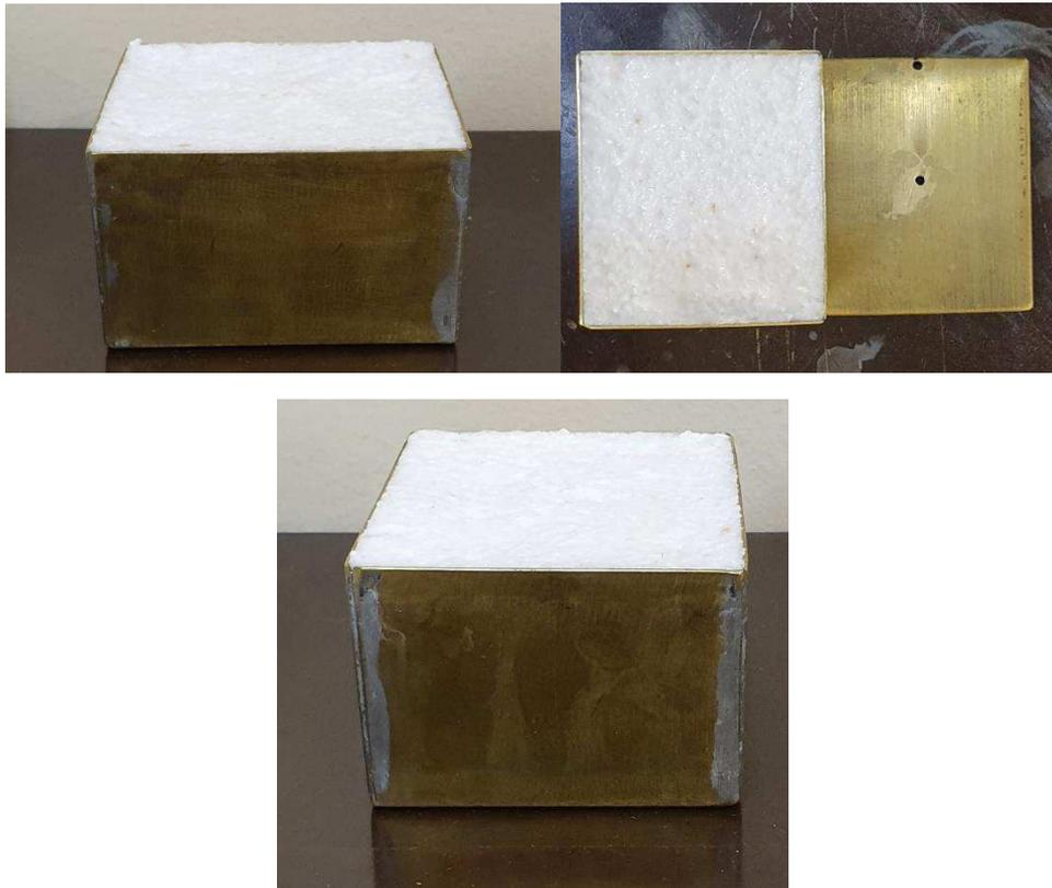
**Figura 3.7** Envaze da polpa do coco verde no recipiente metálico em forma de paralelepípedo.
