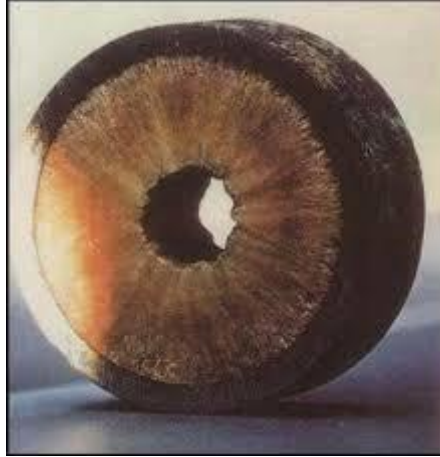
Figura 2.17. Deposição de parafina. Fonte: NTNU (2011)
