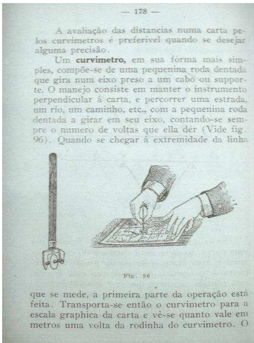
Figura 14: Exemplo do uso do curvimetro. Fonte: GABAGLIA, 192-.
