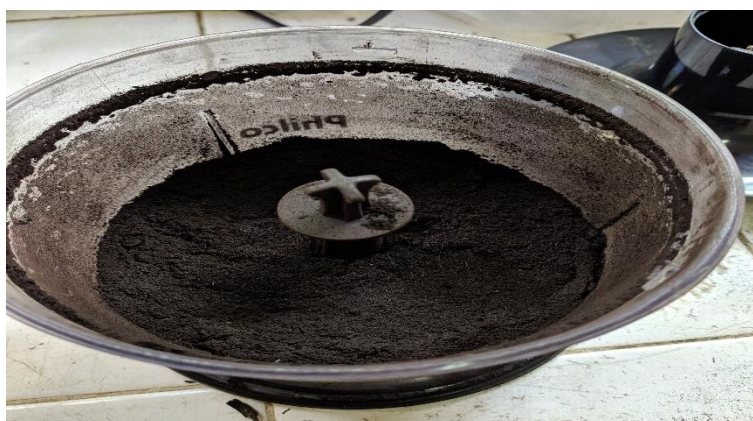
Figura 1. Processo de conversão da biomassa triturada de frutos de coco verde (a) em biocarvão bruto (b) e homogeneização (c) em laboratório.
