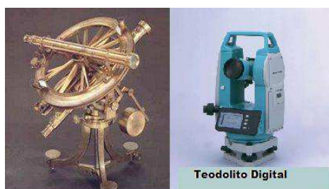
Figura 2.9: Teodolito antigo(esq.) e Teodolito digital(dir.). (Fonte: [12])
