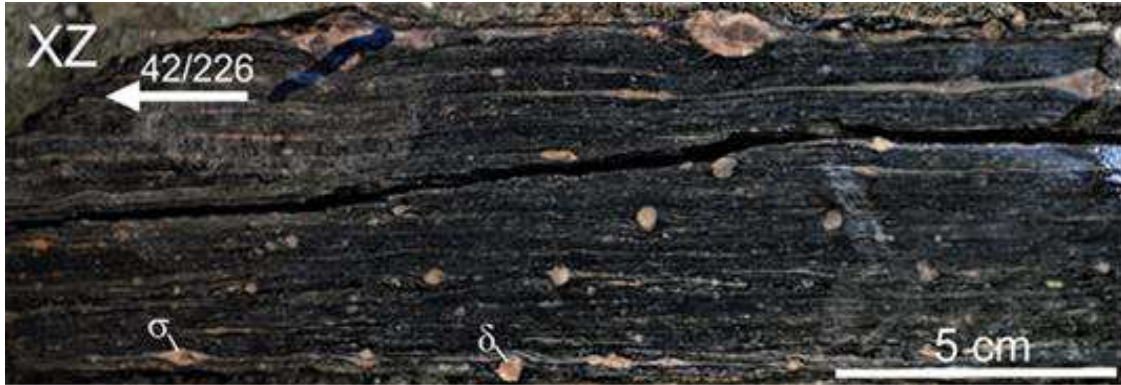
Figura 7.1 – Amostra de milonito da Zona de Cisalhamento Congo mostrando uma seção perpendicular a foliação e paralela a lineação (plano XZ do elipsóide de de formação). A seta mostra a atitude da lineação de estiramento medida em campo. São mostrados porfiroclastos dos tipos \sigma e \delta .
