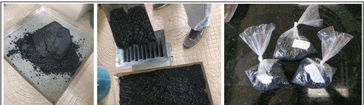
Em seguida, foi realizada via Rotarex a extração do ligante da MAE, de acordo com os procedimentos descritos na DNER-ME 053/94. O solvente utilizado foi a gasolina comum. Após a extração, os agregados da MAE foram colocados para a secagem em estufa por 24 horas para a evaporação total do solvente e realização do ensaio de granulometria. A sequência da extração está representada na Figura 16.
