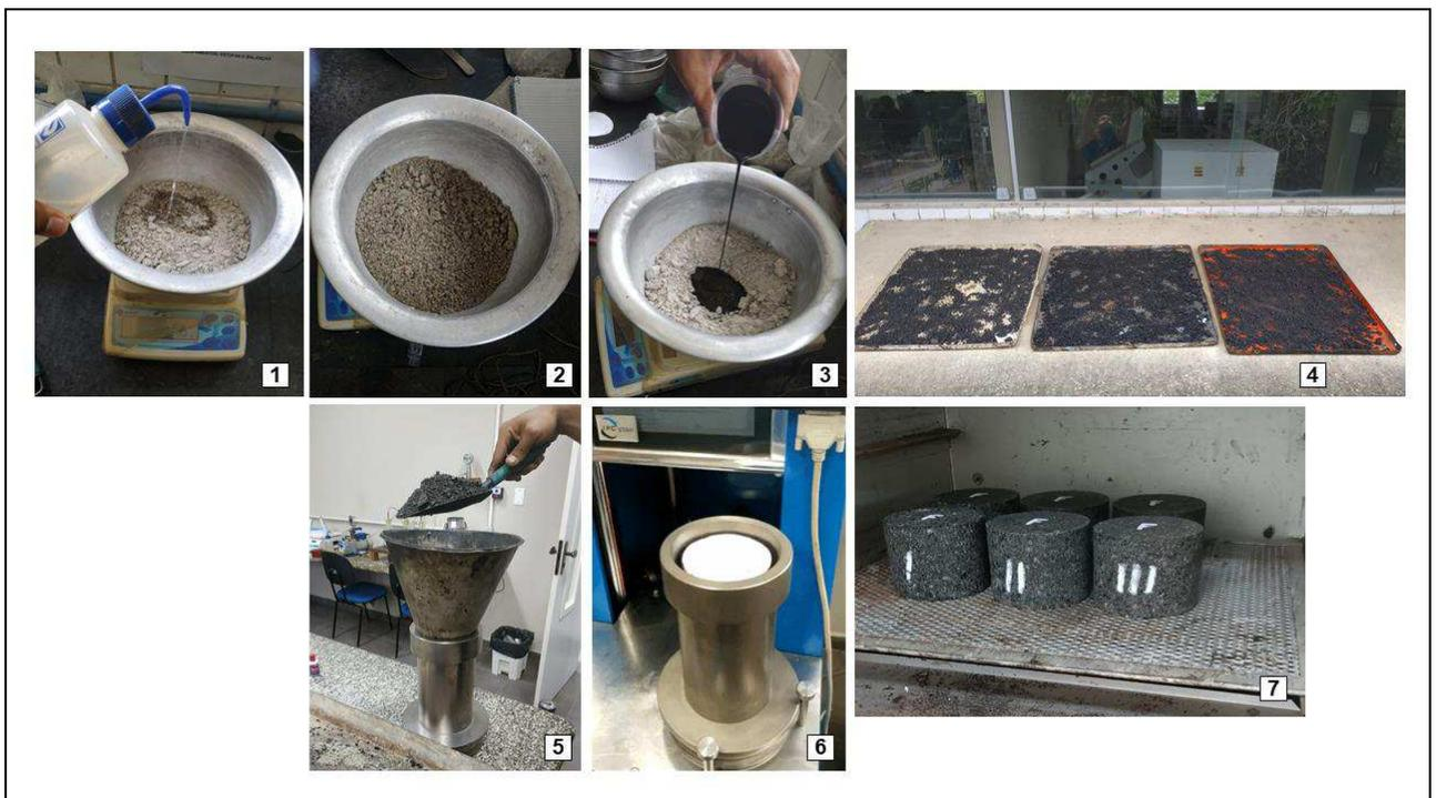
A mistura com os agregados foi realizada de forma manual. Como a emulsão utilizada foi a RL-1C, o tempo de cura adotado foi de 1 hora. A massa de mistura preparada para cada corpo de prova foi de 1200g com um teor de resíduo asfáltico presente na emulsão de 5,12%. Após a moldagem no CGS, os CPs foram submetidos à cura por 24 horas em estufa à 60°C.
