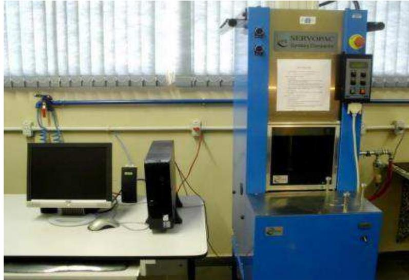
Inicialmente, foram moldados 3 corpos de prova (CPs) teste para a determinação do número de giros a ser adotado nas compactações dos CPs desta mistura.
