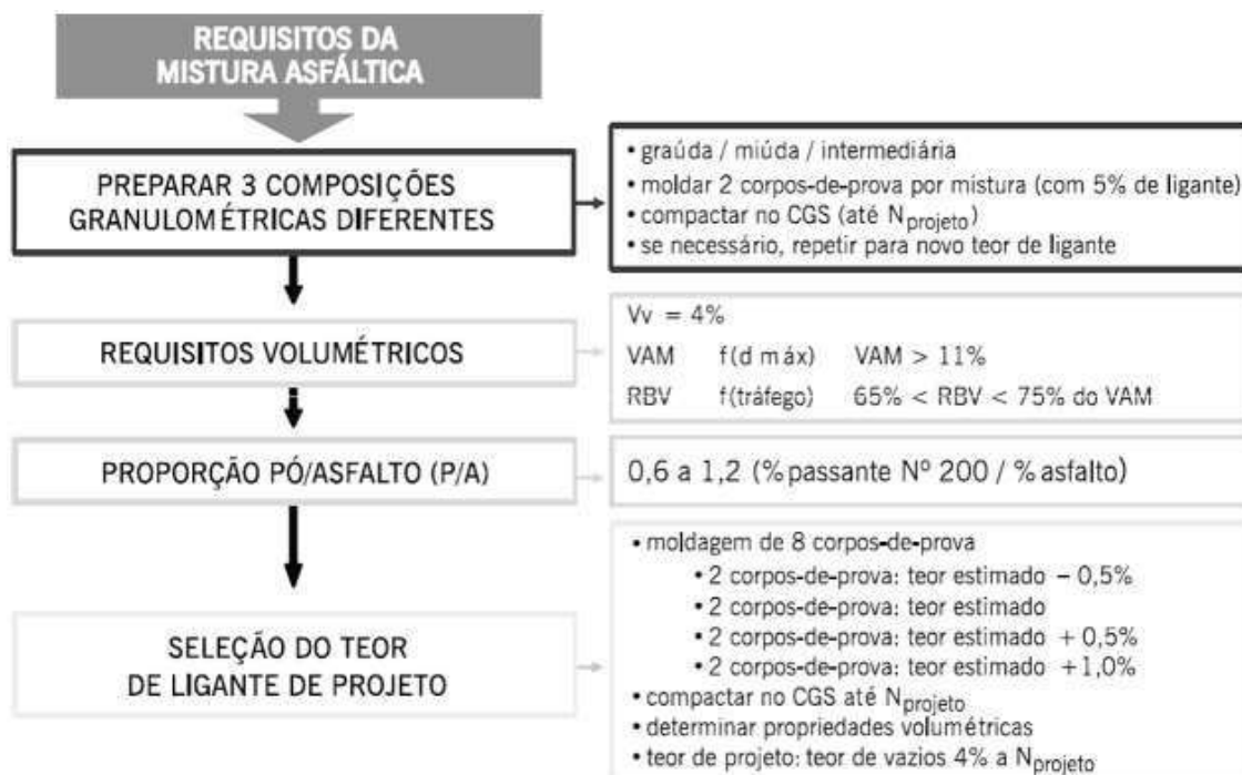
Figura 19 - Fluxograma da dosagem SUPERPAVE
