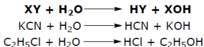
Figura 2.9 - Reações de hidrólise
