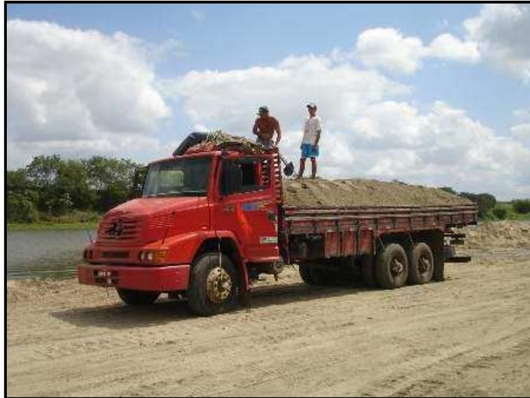
**Figura 18 - Imagem de um caminhão com carroceria inadequada para o transporte de areia (área “1”).**
