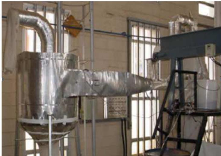
Figura 3.1: (a) Ciclone utilizado por Corrêa (2003) no processo de secagem de bagaço de cana-de-açúcar. Fonte: Corrêa (2003).
