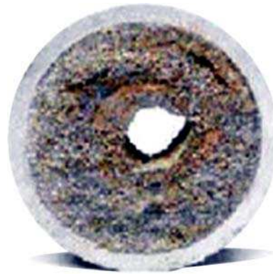
Figura 2.9: Entupimento de duto (precipitação de parafina) circular. Fonte: Azevedo e Teixeira (2003).
