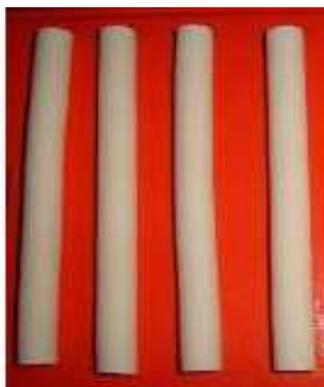
**Figura 15** - Suportes tubulares de alumina para deposição do  $\text{TiO}_2$ .
