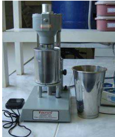
Figura 7: Viscosímetro Fann 35A.
