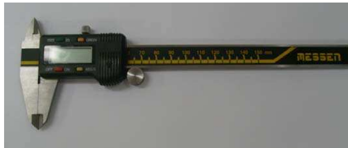
Figura 3.2- Paquímetro digital Messer, com certificado de calibração, 6 polegadas 0,01 e Faixa de Medição: 0 – 150 mm.
