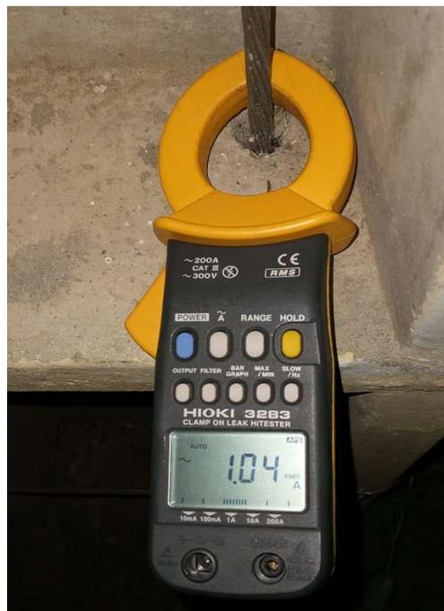
Figura 16 – Alicate amperímetro.
