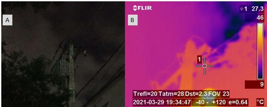
Figura 29 - (A) Transformador 4; (B) Imagem térmica do transformador 4, apontando no ponto 1 uma temperatura do para-raios de aproximadamente 27,3°C.
