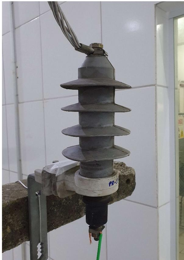
Figura 23 – Para-raios da fabricante DELMAR.
