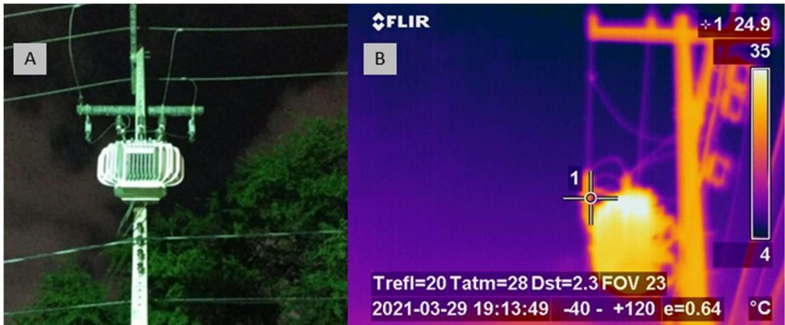
Figura 26 – (A) Transformador 1; (B) Imagem térmica do transformador 1, apontando no ponto 1 uma temperatura do para-raios de aproximadamente 24,9°C.
