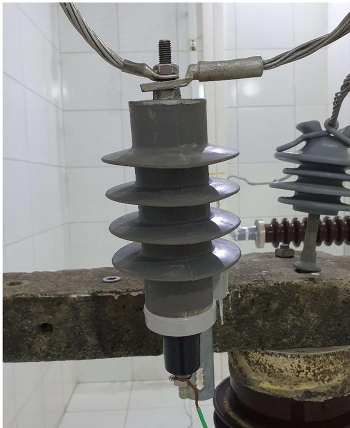
Figura 21 – Para-raios modelo 37B da fabricante BALESTRA.
