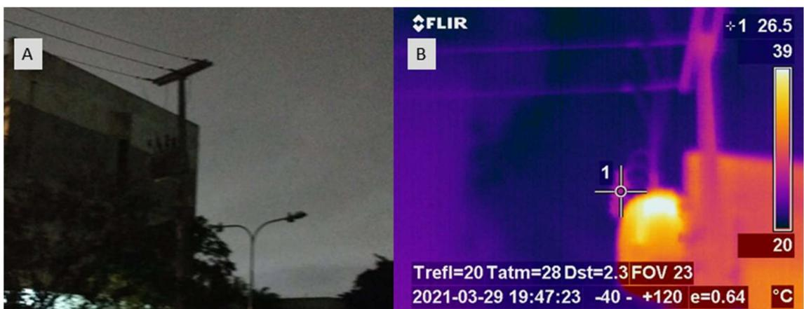
Figura 31 - (A) Transformador 6; (B) Imagem térmica do transformador 6, apontando no ponto 1 uma temperatura do para-raios de aproximadamente 26,5°C.
