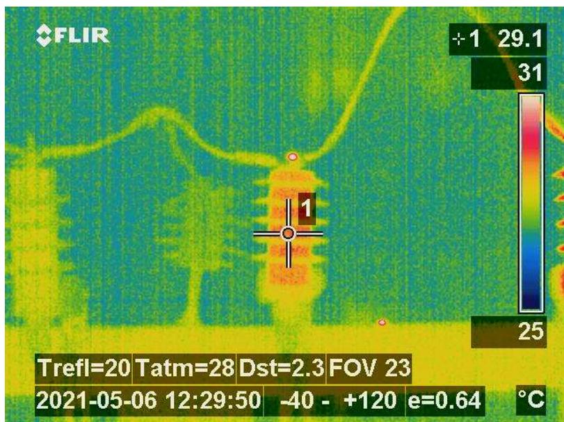
Figura 38 – Imagem térmica do para-raios KEE, o ponto 1 indica 29,1 °C aproximadamente.
