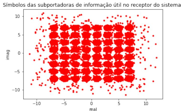
Figura 24 – Constelação 64-QAM das subportadoras no receptor após o filtro casado, para a taxa de amostragem de  $\text{SpS} = 1$  amostra/símbolo. (Próprio autor).
