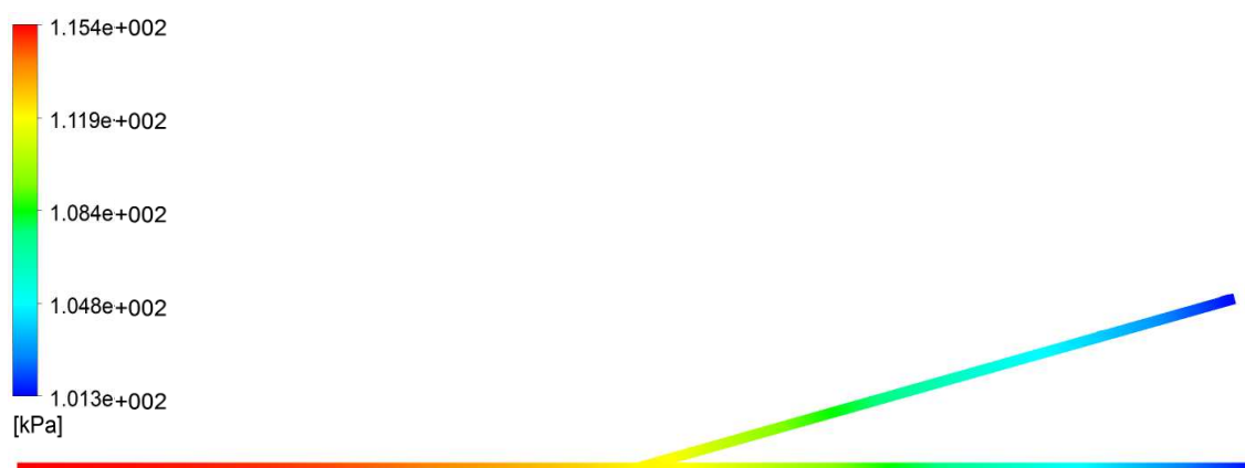
Figura 4.18 - Gradiente de pressão ao longo do duto para uma inclinação de 15°.
