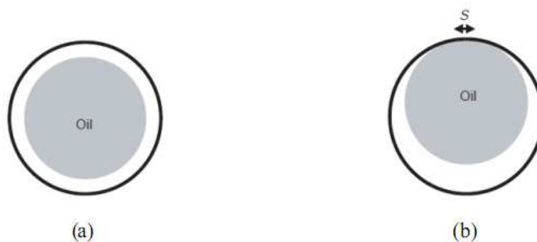
Figura 2.6. Posição radial do “ Core-Flow ”; (a) posição concêntrica ao eixo do tubo e (b) posição excêntrica ao eixo do tubo (Fonte: Bensakhria et al. 2004).
