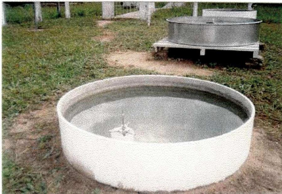
Quadro 3.3. Localização do tanque Classe A C1 e dos tanques de cimento amianto A1 e A2 na área interna do cercado de instrumentos da estação meteorológica, durante a quarta fase experimental
