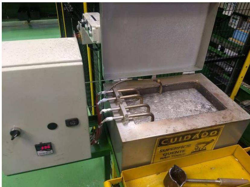
**Figura 16:** Cadinho Móvel Projetado Para Levantamento de Polo
