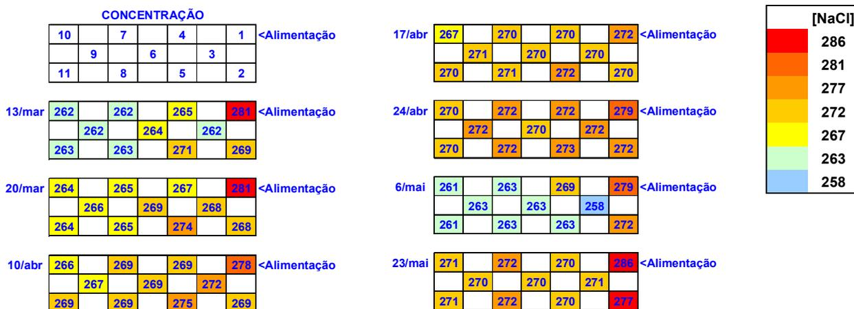
Figura 5-6 – Mapas simplificados dos perfis de concentração de NaCl ao longo da cela, no Teste CI-03.
