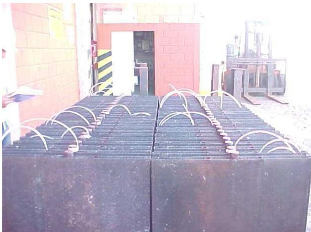
A – Visão geral longitudinal dos ânodos e dos tubos de teflon (11).
