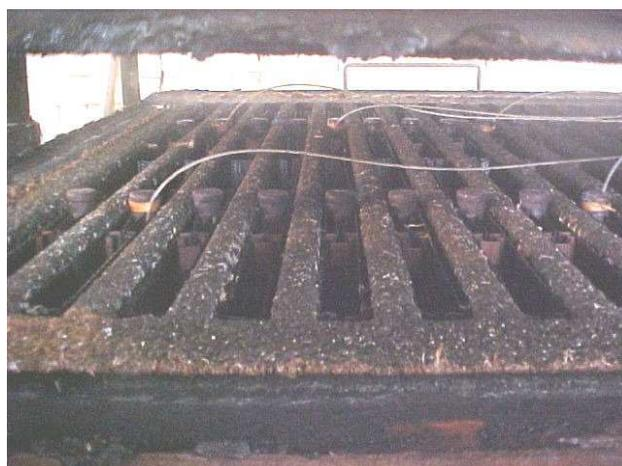
F – Detalhe da fixação de um tubo, durante a abertura da cela retirada de operação.
