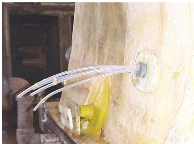
F – Cela já montada, com a tampa. No detalhe, a saída dos tubos, passando pela rolha de borracha. A vedação foi feita com borracha de silicone.
