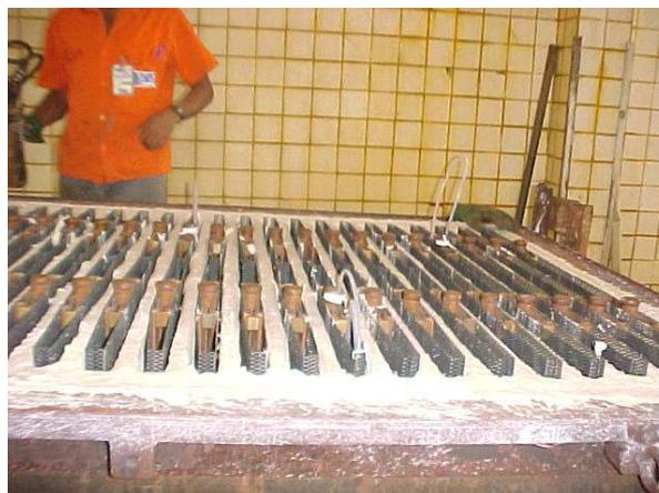
B – Visão geral lateral dos ânodos e dos tubos de teflon.
