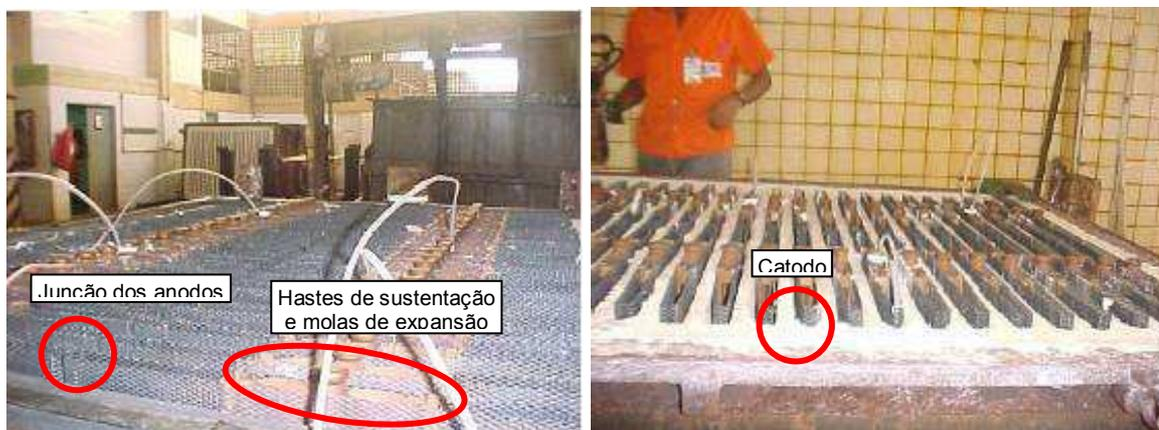
Figura 5-8 – Restrições geométricas dos anodos e catodos.
