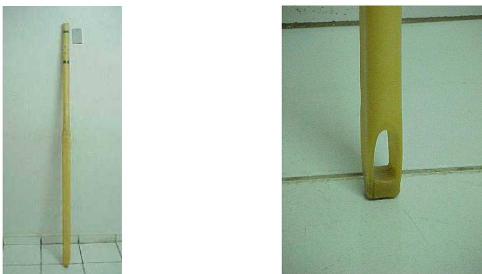
Figura 4-3 – Alimentador das celas H2A e H2A-50, mostrando o detalhe da saída inferior (direita) [fotos gentilmente cedidas pela BRASKEM].
