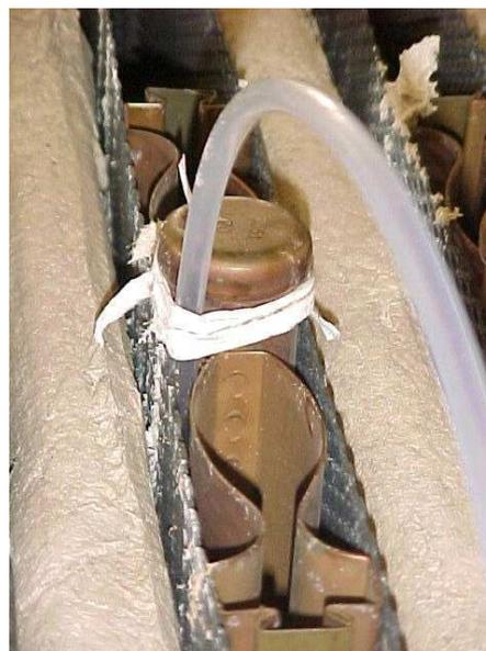
D – Detalhe da fixação de um tubo. Em primeiro plano, vê-se a mola de titânio que sustenta o ânodo e o diafragma modificado, já depositado e curado.
