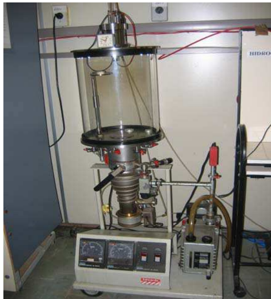
Figura 14. Reator de deposição a plasma por cátodo oco.
