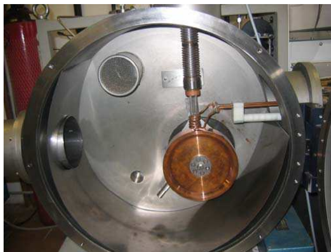
Figura 18 - Equipamento de Processamento por “melt-spinning”.
