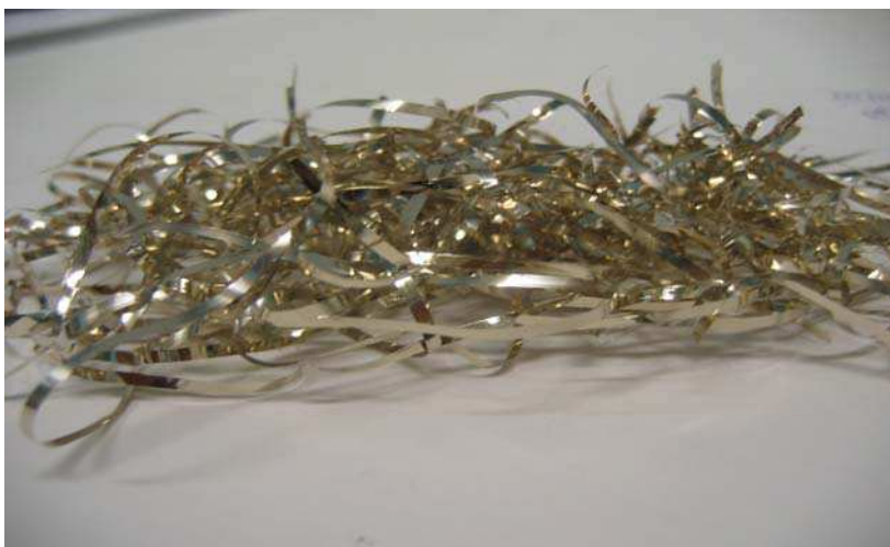
Figura 27 – Fitas processadas por “melt-spinning”- \text{Cu}_{49}\text{Ag}_{45}\text{Ce}_6 .
