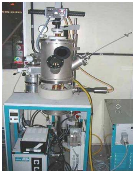
Figura 17. Imagem do forno a arco voltaico.
