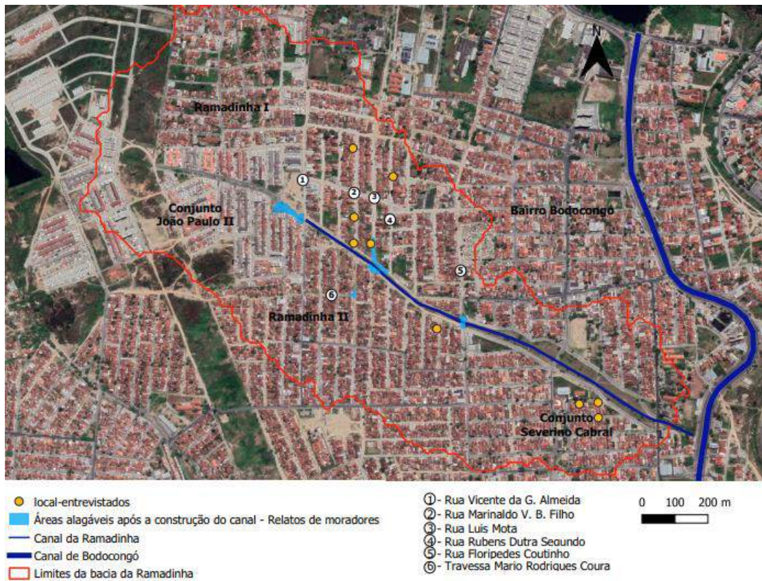
Figura 21: Áreas alagáveis após a construção do Canal da Ramadinha
