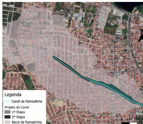
Figura 16: Etapas de execução do Canal da Ramadinha
