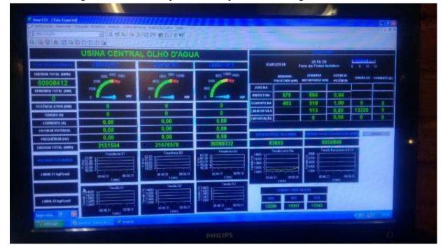
Figura 3: Painel de supervisão dos parâmetros dos geradores.
