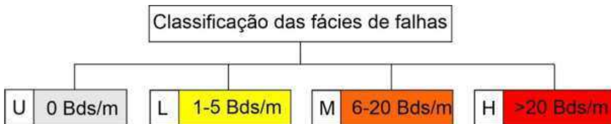
Figura 22: Classificação das fácies de falhas. U= Unstrained/ Sem deformação; L= Low/ Baixa deformação; M: Medium/ Média deformação; H= High/ Alta deformação.
