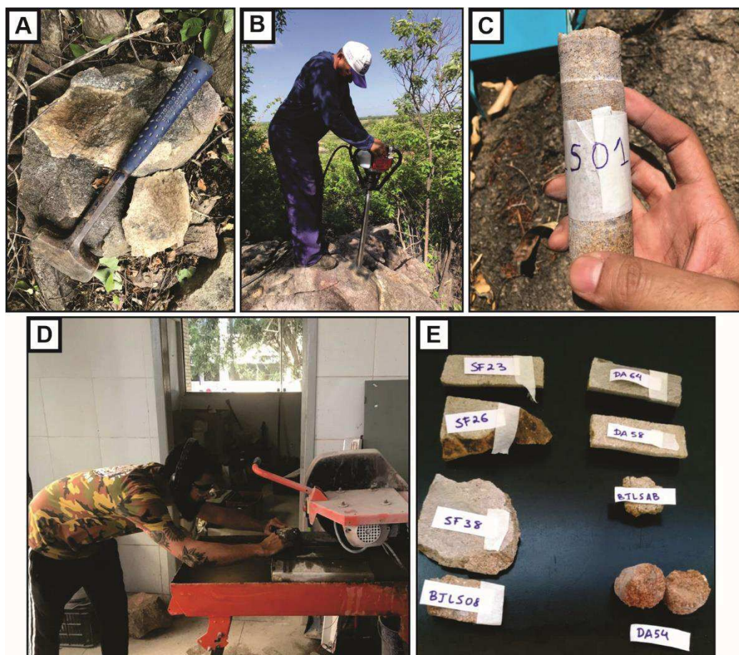
Figura 4.6: (A) coleta de amostras com martelo; (B) coleta de amostras com plugadeira; (C) identificação das amostras; (D) serragem das amostras; (E) encaminhamento de amostras para laminação.
