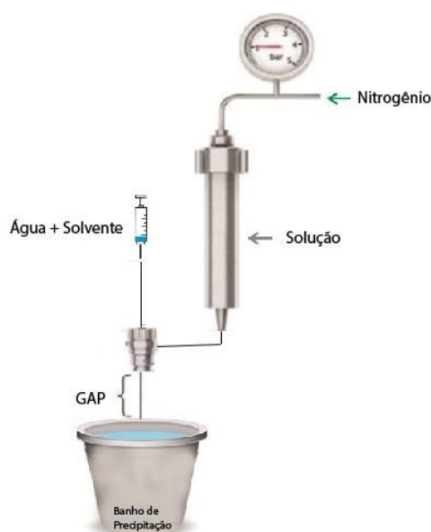
Figura 12 – Representação esquemática do processo de obtenção das membranas de fibra oca simples (Adaptado de Luiten et al. , 2012).
