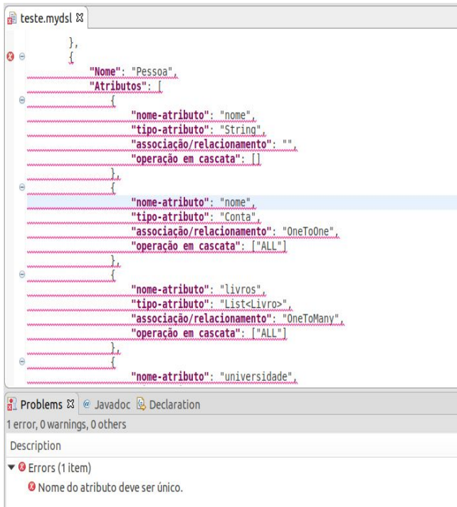
Figura 6. Exemplo de erro detectado na validação quando existem dois atributos com nomes iguais.
