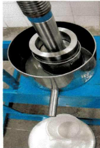
Figura 14 Reservatório de aço inoxidável utilizado na prensagem do óleo de coco catolé
