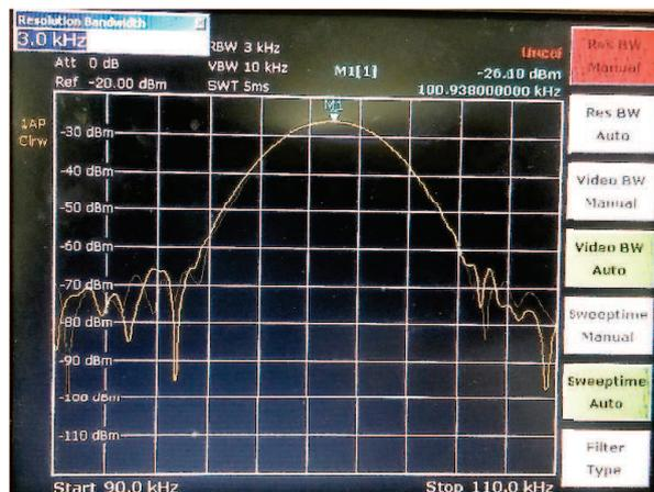
Figura 11 – Visualização dos dois sinais de entrada no analisador de espectro para RBW configurado a 30kHz
