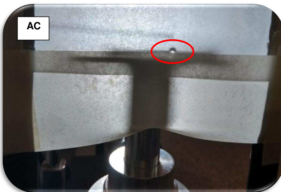
Figura 17 – Molhabilidade por medida de ângulo de contato da amostra AC.
