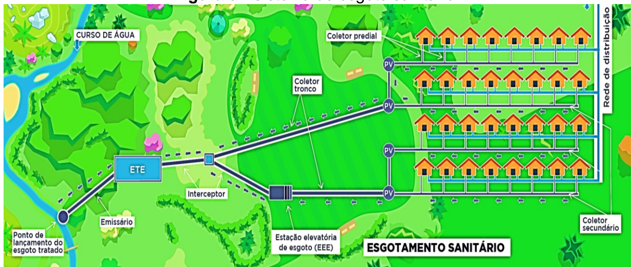
Figura 3 - Sistema de esgoto sanitário
